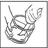
Tout d'abord, remplir le bol de malaxage avec la poudre. Ajouter l'eau et malaxer pendant 30 secondes à la main. Veuillez malaxer le plâtre nécessaire à 3 ou 4 modèles au maximum (important pour la formation des cristaux).
