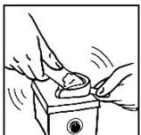
Trabajar la escayola durante 6,0 - 7,0 minutos. Usar el vibrador al nivel más bajo posible. Poner la impresión encima del vibrador evitando el contacto de la impresión con el vibrador. Rellenar la escayola de un sólo lado. No vibrar las impresiones una vez rellenas.
