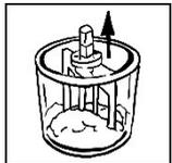
Mezclar al vacío por 45 segundos, a vacío de 80 %, 300 rev./min. Sólo empezar a poner el agitador hasta que el vacío esté establecido absolutamente. Siempre dejar los vasos de mezcla no necesitados llenados con agua.
