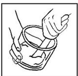
Primero rellenar el vaso de mezcla con el polvo de escayola, luego añadir agua y mezclar a mano por aprox. 30 seg. Sólo mezclar la cantidad de escayola que se necesita para tres ó cuatro modelos (importante para la cristalización).
