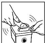
Trabajar la escayola durante 3,5 - 4,5 minutos. Usar el vibrador al nivel más bajo posible. Poner la impresión encima del vibrador evitando el contacto de la impresión con el vibrador. Rellenar la escayola de un sólo lado. No vibrar las impresiones una vez rellenas.
