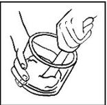
Tout d'abord, remplir le bol de malaxage avec la poudre. Ajouter l'eau et malaxer pendant 30 secondes à la main. Veuillez malaxer le plâtre nécessaire à 3 ou 4 modèles au maximum (important pour la formation des cristaux).
