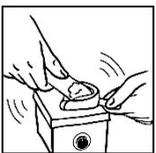
Travailler le plâtre pendant ca. 2,5 minutes. Placer le vibreur sur son intensité la plus faible. Placer le porte-empreinte à plat et empêcher un contact direct entre matériau d'empreinte et vibreur. Verser le plâtre par un seul côté de l'empreinte. Ne plus vibrer après avoir coulé l'empreinte.
