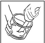
Primero rellenar el vaso de mezcla con el polvo de escayola, luego añadir agua y mezclar a mano por aprox. 30 seg. Sólo mezclar la cantidad de escayola que se necesita para tres ó cuatro modelos (importante para la cristalización).
