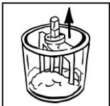
Gipspulver zuerst in den Anrührbecher füllen, dann Wasser dazugeben und von Hand zügig durchmischen, bis sich Pulver und Flüssigkeit gut vermischt haben. 45 Sekunden unter Vakuum mischen bei 80 % Vakuum, 300 U/min. Das Rührwerk erst einschalten, wenn das Vakuum vollständig steht. Nicht benötigte Anmischbecher immer mit Wasser befüllt stehen lassen.
