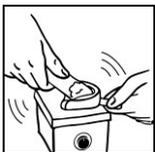
Den Gipsbrei innerhalb von 4,0 – 5,0 Minuten verarbeiten. Rüttler auf schwächste Stufe stellen. Löffel flächig auflegen, dabei Kontakt des Abdruckmaterials mit dem Rüttler vermeiden. Gips nur von einer Seite einlaufen lassen. Ausgegossenen Abdruck nicht mehr rütteln. Danach sollte der Gips für eine gute Kristallisation und das Abbinden ungestört aushärten, um Splintern, Abplatzungen oder Brüche zu vermeiden.
