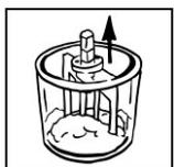
Gipspulver zuerst in den Anrührbecher füllen, dann Wasser dazugeben und von Hand zügig durchmischen, bis sich Pulver und Flüssigkeit gut vermischt haben.
