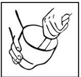
Gipspulver zuerst in den Anrührbecher füllen, dann Wasser dazugeben und von Hand langsam rühren, bis sich Pulver und Flüssigkeit gut vermischt haben, anschließend 45 Sekunden spateln. Handanmischung gesamt 60 Sekunden.
