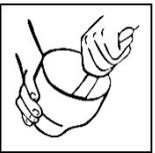
Gipspulver zuerst in den Anrührbecher füllen, dann Wasser dazugeben und von Hand zügig durchmischen, bis sich Pulver und Flüssigkeit gut vermischt haben. Handanmischung gesamt ca. 30 Sekunden.
