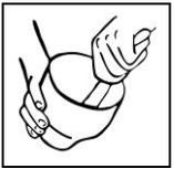
Llenar el vaso de mezcla primero con polvo, después añadir agua y espatular enérgicamente hasta que el polvo y el agua estén bien mezclados. Mezcla manual total de aprox. 30 segundos.
