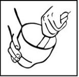
Verser le plâtre dans le bol et ajouter l'eau. Mélanger lentement à la main jusqu'à ce que la poudre et l'eau soient bien mélangées. Malaxage à la main: au total 45 secondes.
