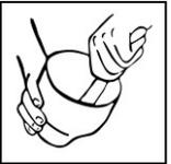
Verser le plâtre dans le bol et ajouter l'eau. Mélanger lentement à la main jusqu'à ce que la poudre et l'eau soient bien mélangées, ensuite malaxer pendant 45 secondes. Malaxage à la main: au total 60 secondes.
