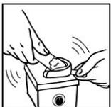
Travailler le plâtre pendant 4,0 - 5,0 minutes. Placer le vibreur sur son intensité la plus faible. Placer le porte-empreinte à plat et empêcher un contact direct entre matériau d'empreinte et vibreur. Verser le plâtre par un seul côté de l'empreinte. Ne plus vibrer après avoir coulé l'empreinte. Ensuite, pour une bonne cristallisation et durcissement, le plâtre doit durcir sans être perturbé afin d'éviter les éclats, les écaillage ou les fractures.
