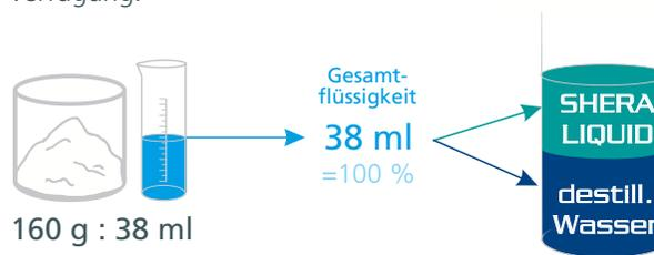
Bei Presskeramik benötigen Sie für einen Einbettmassenbeutel à 160 g insgesamt 34 ml Flüssigkeit. Die Abmischung der Flüssigkeit entnehmen Sie bitte dieser Tabelle:
