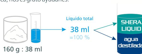
Para trabajos de cerámica inyectada se necesita 34 ml de líquido total para una bolsita de 160 g de revestimiento. La proporción de mezcla se encuentra en esta tabla:
