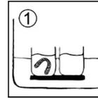
Pulire gli oggetti stampati in un recipiente separato con pulitore ad ultrasuoni per un massimo di tre minuti in un bagno ad ultrasuoni. Spazzolare delicatamente aperture, fori e spazi vuoti con uno spazzolino morbido.
