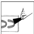
Rimuovere i manufatti stampati finiti e qualsiasi residuo polimerizzato dalla piattaforma di costruzione con una spatola.
