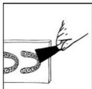
Retirar con una espátula los trabajos ya impresos y cualquier residuo polimerizado de la plataforma de construcción.
