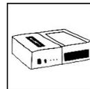
Posexposición de los objetos de impresión en el Otofash G171 (óptica NK) o en un aparato similar con 2 x 2000 relámpagos en atmósfera de gas protector (nitrógeno).
