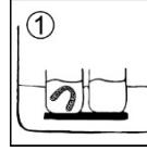
Immergere gli oggetti stampati in un contenitore separato contenente SHERAultra-p, trattando il tutto in bagno ad ultrasuoni per un massimo di tre minuti. Spazzolare delicatamente le aperture, i fori e le fessure con una spazzola a setole morbide.
