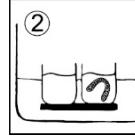
Ripetere la procedura in un contenitore separato con SHERAultra-p, sempre per un massimo di tre minuti (il tempo complessivo non deve superare i 10 minuti). Per la fase di asciugatura, soffiare delicatamente gli oggetti con aria compressa.
